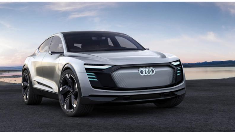
Il principio di funzionamento di quest'auto è abbastanza semplice, una batteria contiene una quantità immensa di energia elettrica, questa viene trasferita all'interno di un motore elettrico che senza scatola del cambio trasferisce l'energia meccanica prodotta direttamente nelle ruote.
